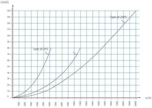
Die Druckverlustkurven hängen von der Luftmenge
